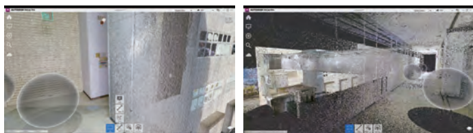
ReCAP Proによる点群データのレビュー(視点移動)
