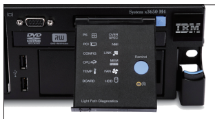
Light-Path 診断パネル: ラック型は前面、タワー型は正面カバーの中に診断パネルを搭載
