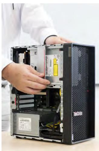
ツールレスの筐体を採用しており、赤い印の付いているパーツは手で簡単に取り外しや接続解除が可能
